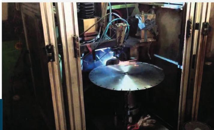
Soudure laser disque diamant
