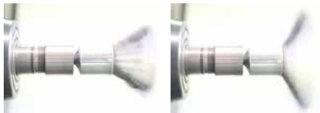
Les brosses SIT sont soumises à des tests d'acceptation conformément à la norme UNI EN 1083 qui définit les critères de sécurité relatifs à la fabrication des brosses.
