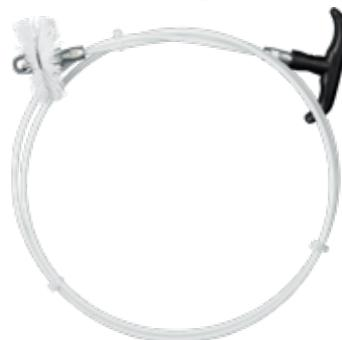
Kit formé d'une canne en fibre de verre extrêmement résistante et flexible, avec une poignée en plastique qui en facilite l'emploi, 1 ou 2 disques de Nylon de première qualité et une fermeture avec écrou M12 (KIT Light) ou avec une boule noire M12 qui guide l'écouvillon même dans les courbes à 90 degrés!
